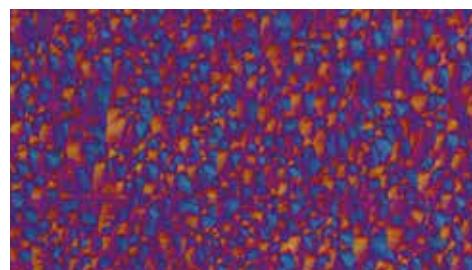
聚乙烯箔，带入板的交叉偏振光镜，放大 20倍。
