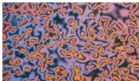
液晶，混合排列晶胞中的缺陷织构。交叉偏振光镜，放大5倍。
