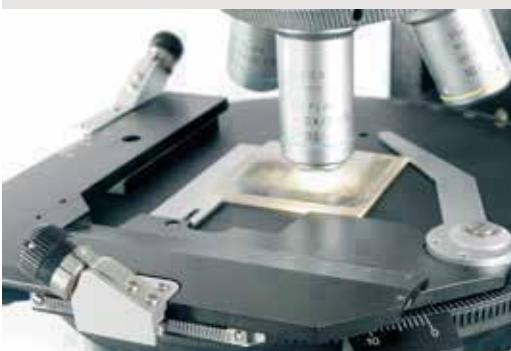
灵活性至关重要。所有徕卡旋转载物台偏振显微镜均配置可连接、可互换的机械载物台。
