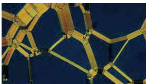
胆甾醇混合液晶的油丝织构。
